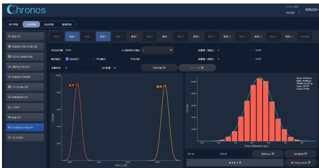
图 129 全局时间-能谱符合测量结果（输入正脉冲，频率 1 MHz，幅度+4V，通道 1 和 3，典型结果）
