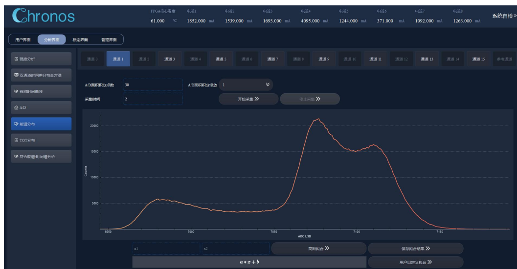
图 127 能谱外部输入信号测量结果（输入负脉冲，频率 1 MHz，幅度-2V，通道 1，典型结果）
