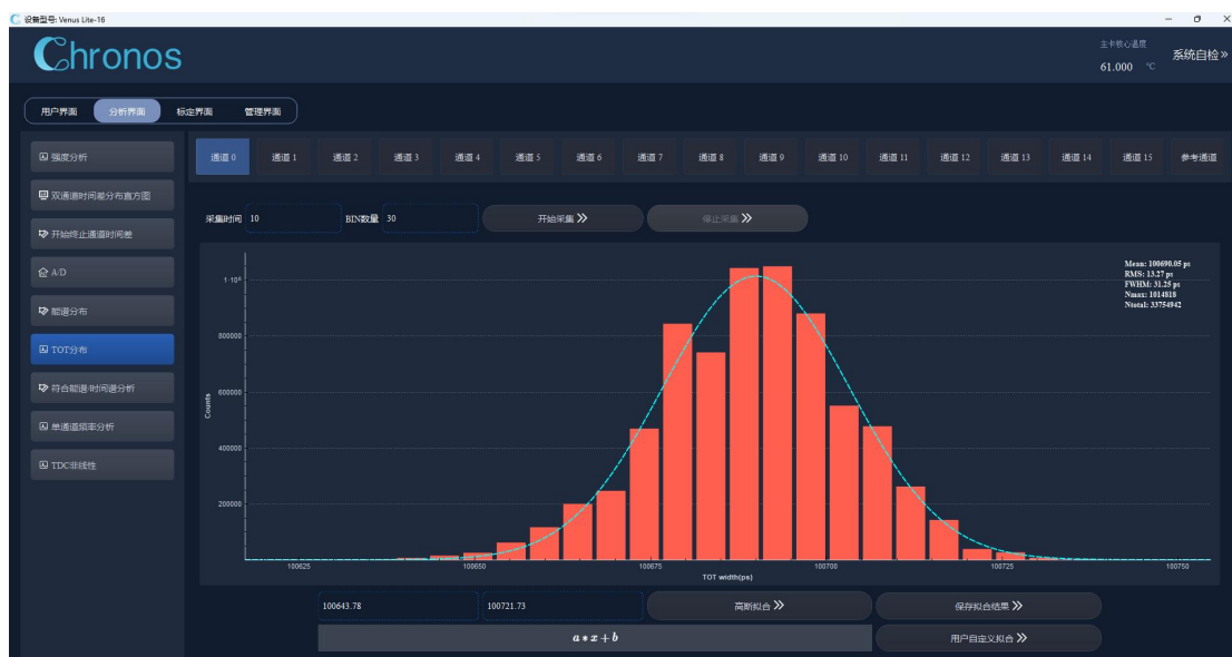
图 118 TOT 外部输入信号测量结果（高分辨率通道，通道 0，典型结果）
