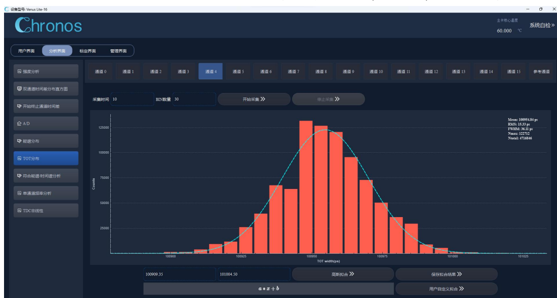
图 119 TOT 外部输入信号测量结果（普通通道，通道 4，典型结果）
