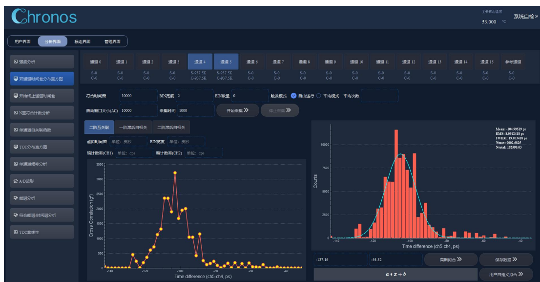
图 106 普通通道双通道时间差分布直方图典型测试结果（内部触发，上升沿，CH4/5）
